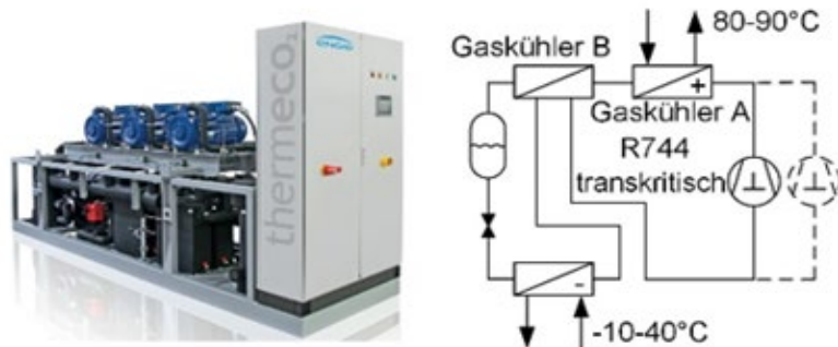
ENGIE (ex-Dürr Thermea), thermeco 2 HHR1000 mit 6 Hubkolbenverdichtern bis 1100 kW
